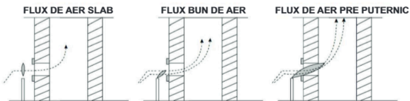
Figure No. 2 VERIFICAREA TIRAJULUI DE AER LA COȘ
